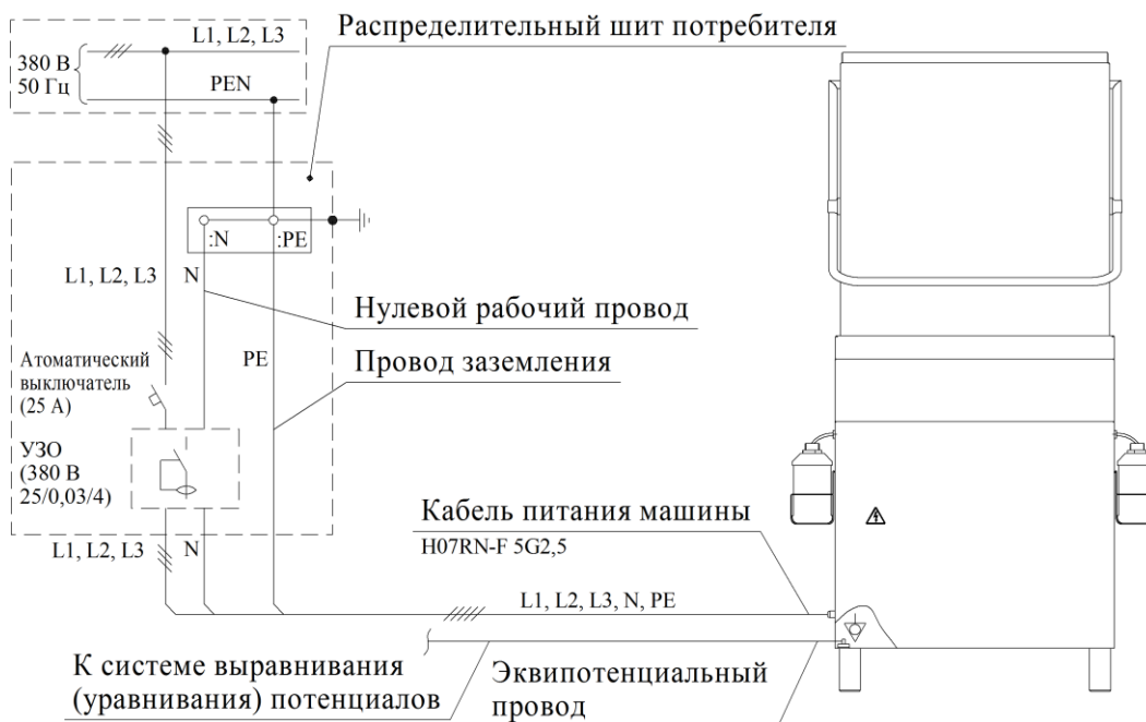
Рисунок 7 – Схема электрическая подключения машины к электрической сети
